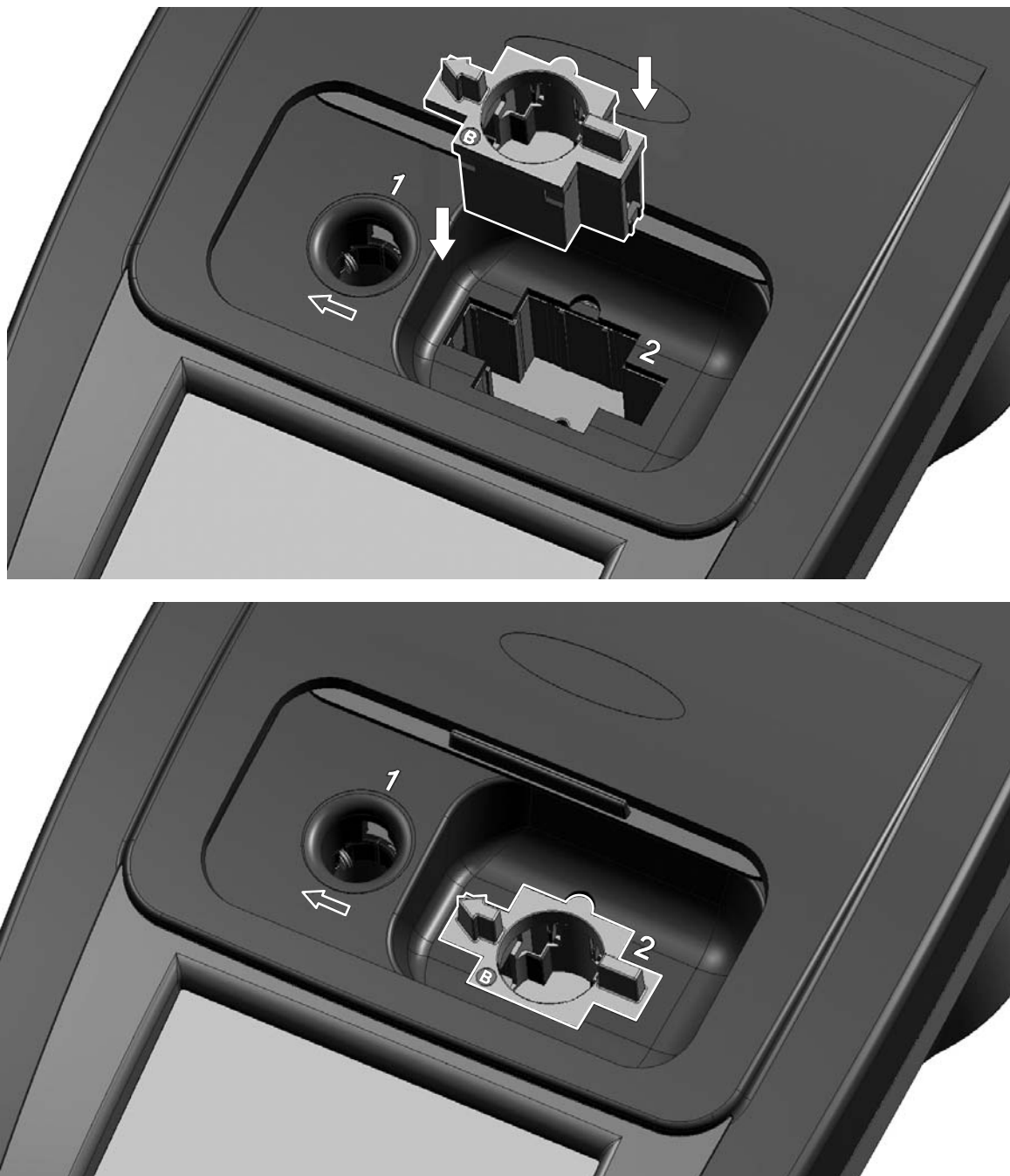
Figura 4 Instalación de un adaptador de cubetas
