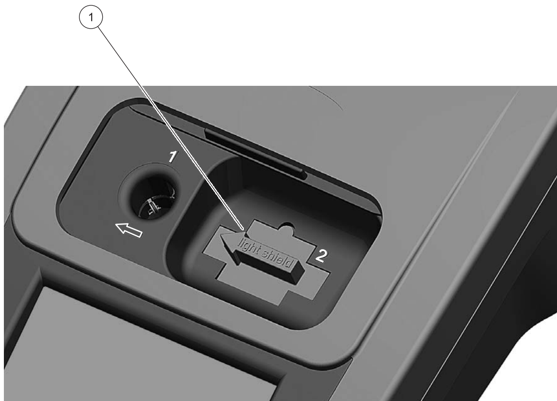
Figura 6 Protector de luz instalado
