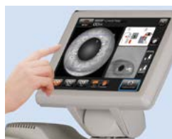
Ajustar la posición de la mentonera y pulsar [Start CAPTURE] (Iniciar CAPTURA)
